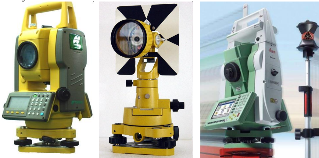
Slika 15. Savremeni elektromagnetni daljinomjeri i izgled prizme
